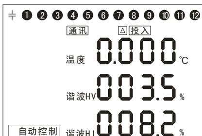
显示安装用电现场的温度；总谐波电压畸变率 HV；总谐波电流畸变率 HI。
