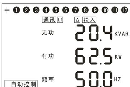
显示安装用电现场的 P、Q、F。
