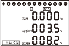
图11 显示安装用电现场的温度；电压总谐波畸变率HV；电流总谐波畸变率HI。
